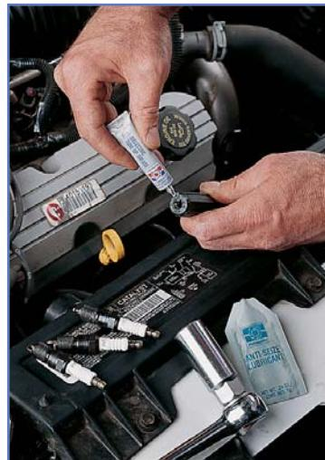
Набор включает два пакетика со специальными смазками, которые рекомендуется использовать при замене свечей зажигания.
