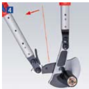
Открыть ручки по принципу трещоточного ключа после первого частичного реза.
