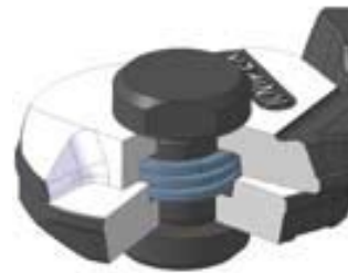
С внутренней раскрывающей пружины
