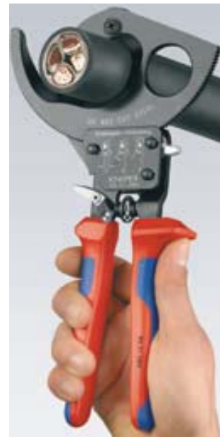
Принцип трещоточного ключа и двухходовый шестеренчатый привод для резания с меньшим усилием
